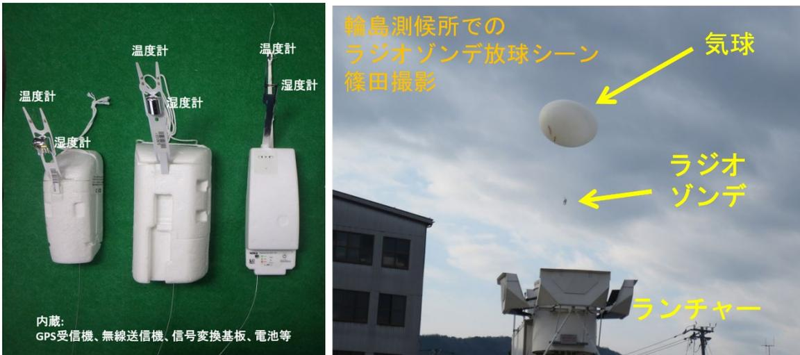
図 2-1 (左) 気象庁で使用しているラジオゾンデ。気象庁の解説サイトより引用 (<https://www.jma.go.jp/jma/kishou/knownupper/kaisetsu.html>)。(右) 自動放球装置からのラジオゾンデ放球風景。
