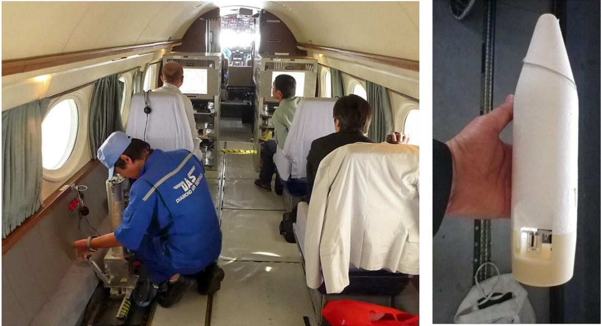
図 2-4 (左) G-II の機内風景。手前の青い服を着ている方が操作しているものがドロップゾンデの投下装置（シュータ）です。前方のラックに収められている機器がドロップゾンデの受信機です。G-II の搭乗可能人員は 7 名でした。(右) ドロップゾンデ本体。写真の姿勢で落下していくと考えられる。下部に温度センサと湿度センサがある。
